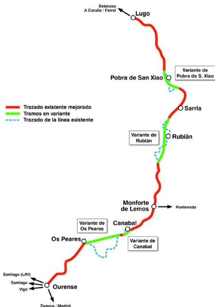
Figura 6. Esquema de la modernización de la línea Lugo - Ourense planteada en el Estudio Informativo licitado por el Ministerio de Fomento en 2000
