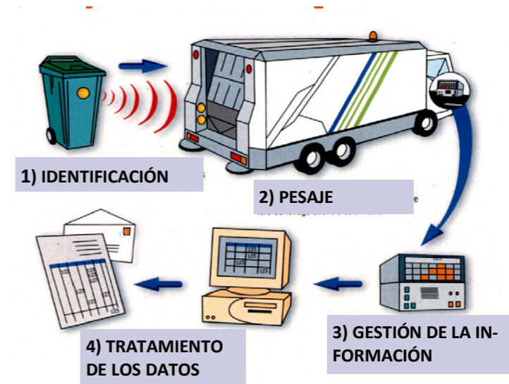
Fig12. Funcionamiento del sistema de recogida y facturación
